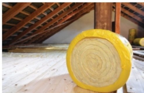
Wełna mineralna - materiał izolacyjny stosowany m.in. do izolacji dachów i poddaszy
